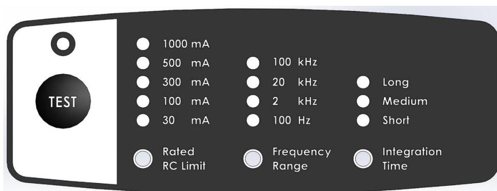
**Variabler Differenzstrommonitor vom Typ B / B + zur Messung von DC- und AC-Differenzströmen bis 100 kHz mit analogem 4-20 mA- und Relaisausgang. Differenzstrom und Frequenzbereich sowie Integrationszeit sind flexibel einstellbar.**
